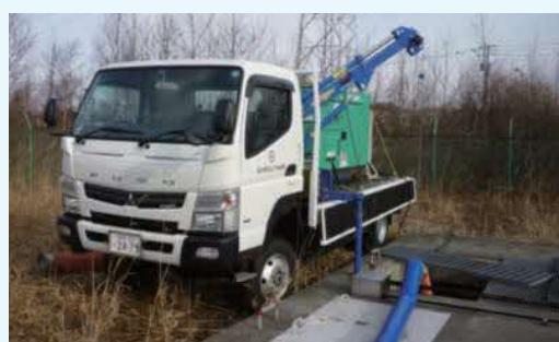
下水道管の能力を超える大雨により、道路冠水が予測される場合には、「雨水排水ポンプ車」を配備し、強制排水を行うことで、浸水被害の軽減に努めています。
